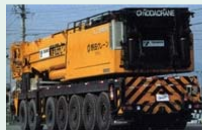
オールテレーンクレーン 全長 17.46m
